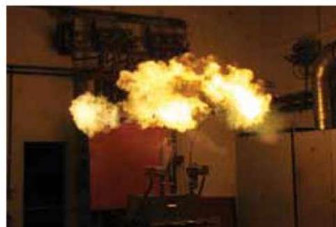
Electrical endurance test / Prova di durata elettrica
